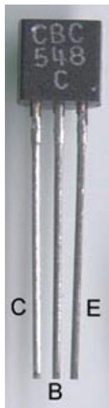
*Abbildung 2: Pin-Belegung der npn-Transistoren BC547 und BC548*
